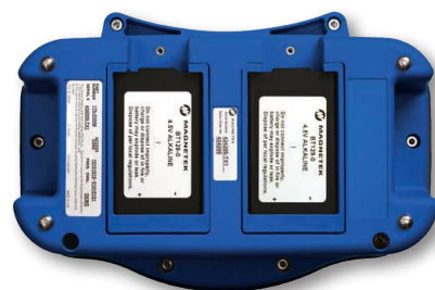
Blocs batterie principale et batterie de secours
