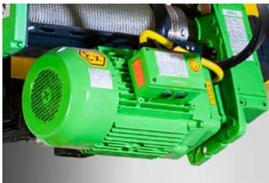
Motoren für Zone 1 und Zone 21 sind aus Grauguss gefertigt, die Schutzart ist kombiniert aus druckfester Kapselung ›db‹, erhöhter Sicherheit ›eb‹ und Schutz durch Gehäuse ›tb‹. Für Zone 2 sind die Motoren aus Aluminium und in der Schutzart, erhöhte Sicherheit ›ec‹. Für Zone 22 sind die Motoren in IP66 und Schutz durch Gehäuse ›tc‹ ausgeführt.
