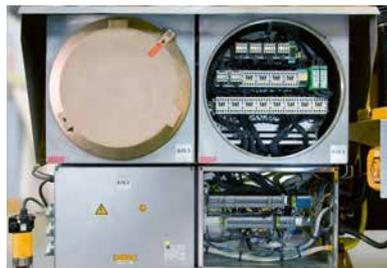
Schutzart der Gerätekästen bei Zone 1, Zone 2 und Zone 21 an Kran und Hebezeug kombiniert aus den Schutzarten druckfeste Kapselung ›db‹, erhöhte Sicherheit ›eb‹ und Schutz durch Gehäuse ›tb‹.
