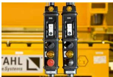
Die Steuergeräte SWH 5 ex sind speziell für die Steuerung von Hubwerken und Kranen in explosionsfähiger Umgebung ausgelegt. Bei explosionsgeschützten Seilzügen wird das zweistufige Steuergerät SWH ex in der Schutzart druckfeste Kapselung »db« und erhöhte Sicherheit »eb«, sowie in IP66 und Schutz durch Gehäuse »tb« eingesetzt.
