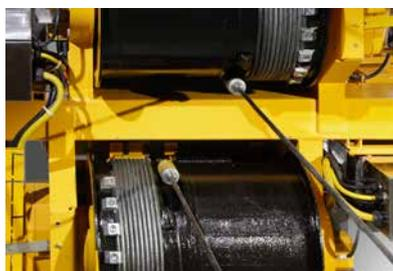
Spezielseiltrommel zur Aufnahme eines Arbeitsseils mit Aussparung für den Schnellverschluss optional erhältlich.
