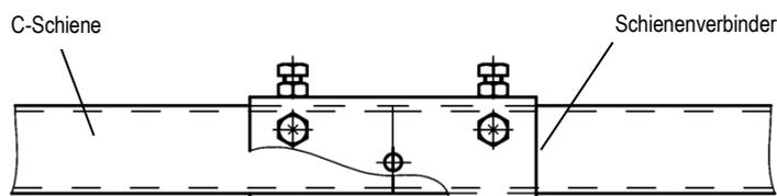
Abb. 30: Schienenverbinder
