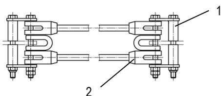
Abb. 25: Dämpfungseinrichtung
