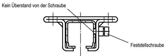
Abb. 29: Sichern der Schiene gegen Herausrutschen
