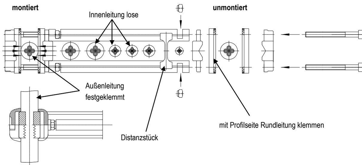
Abb. 42: Montage Rundleitungsklemme
