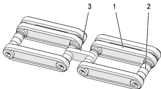
Abb. 24: Flachleitungsklemme
