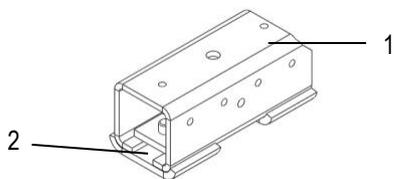
Abb. 10: Anschweißhalter für Spannarme
