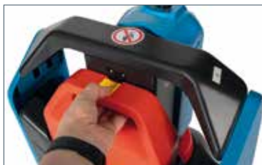
Sekundenschneller Akkuwechsel – mit einem Handgriff
