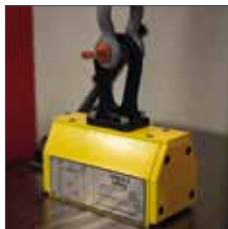
Lasthebemagnet TPM 0,3 zum Belastungstest im Prüfstand RPYS-1215 mit Prüfplatte für Permanentmagnet AYP-1215-S
