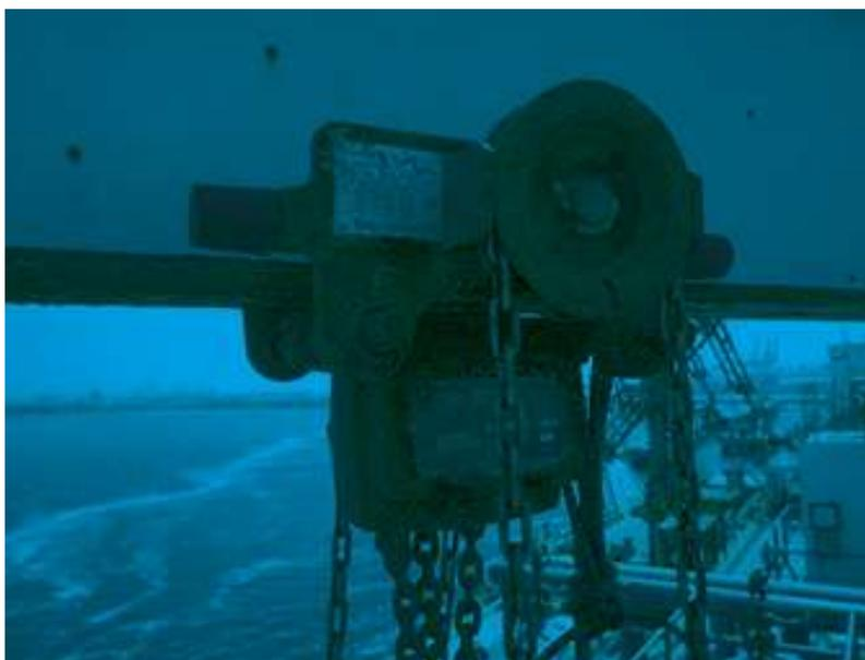
Corrosion sur un Yalelift avec chariot intégré
