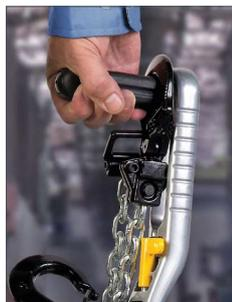
La poignée permet de transporter le palan facilement, comme une poignée de transport.. Simplyment relier l'arrêt de chaîne au crochet, et le crochet sur la poignée.
