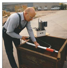
Redressement d'un container avec un vérin YS-10/100, équipé d'une rallonge AYS-106 et d'une embase AYS-103, actionné par une centrale PY-04/2/5/2 M.
