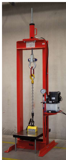
Aimant permanent TPM 0,3 pour banc d'essai RPYS-1215 complet avec plaque d'essai AYP-1215-S
